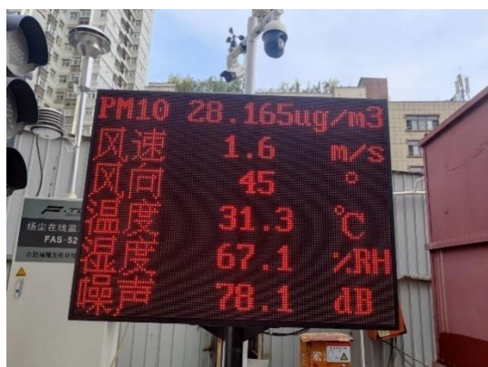
扬尘监控系统监测
