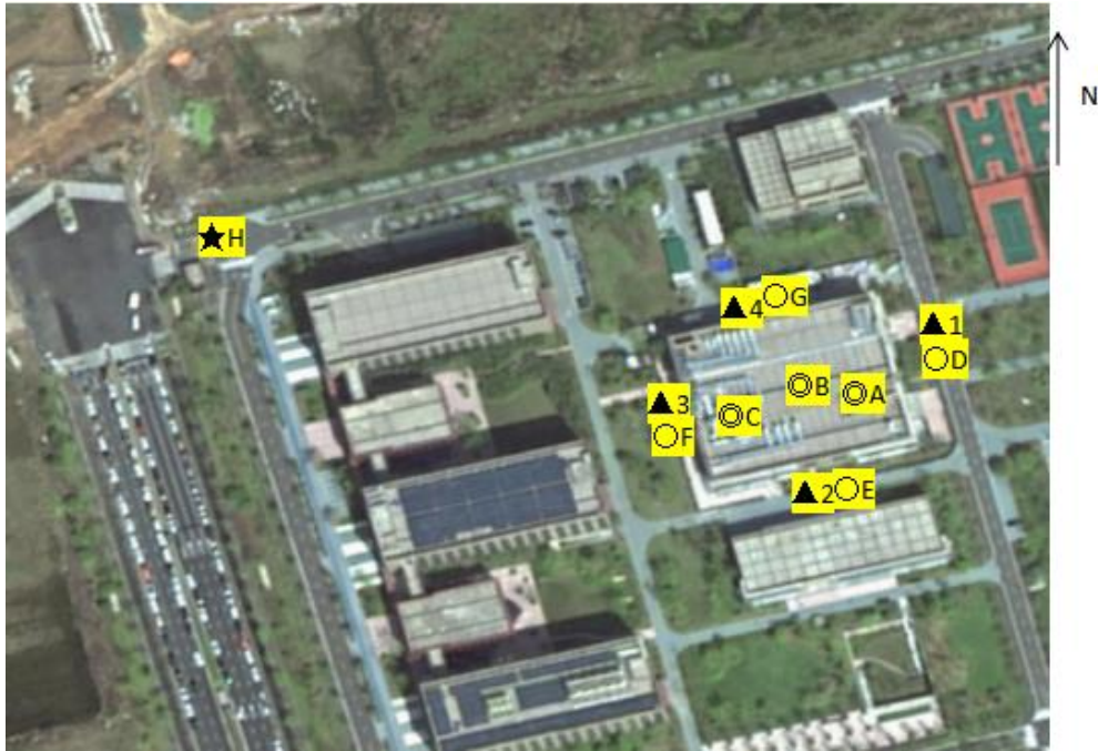
注：★为废水采样点，◎为有组织废气采样点，○为无组织废气采样点，▲为噪声检测点。 图6-1 废气、废水和厂界环境噪声检测点位示意图
